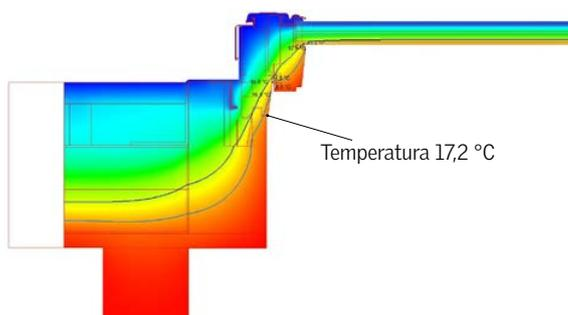
Utilizzando il sistema di posa con imbotte strutturale isolato, si raggiungono elevate temperature superficiali nel punto di appoggio tra il telaio fisso della finestra VELUX e la copertura. Tali temperature rispettano gli standard di **FinestraQualità CasaClima** assicurando:
